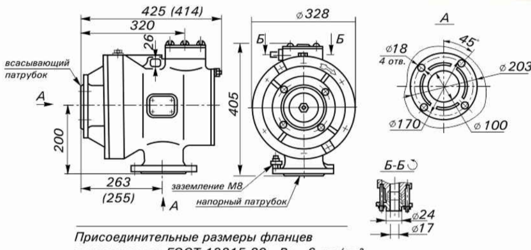
Габаритный чертёж электронасоса МТТ-16/10
